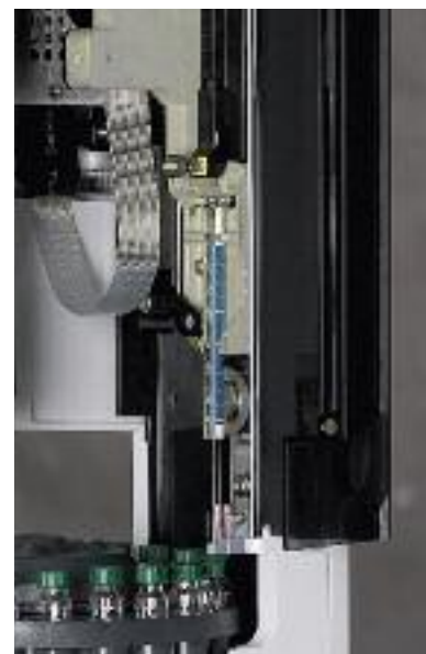
Jeringa para inyector automático de línea azul en el sistema ALS 7693A, G4513-80204
