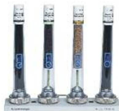
Filtros de purificación de gases
