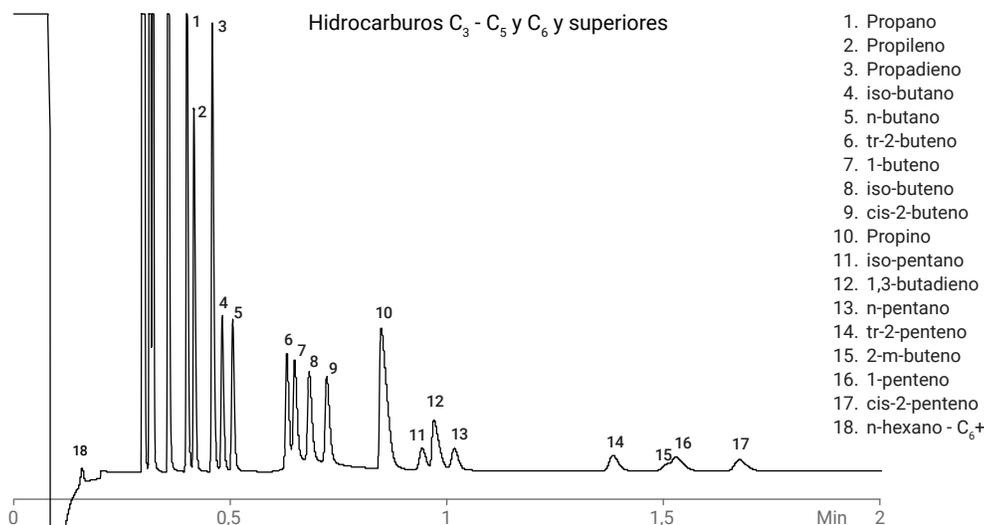
El sistema Micro GC Agilent 990 puede medir 17 gases de refinería diferentes en menos de dos minutos.
