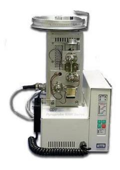
El 2500 es un sistema totalmente automatizado de pirólisis para GC y GC-MS. Incluye el controlador del pirolizador y del automuestreador.
