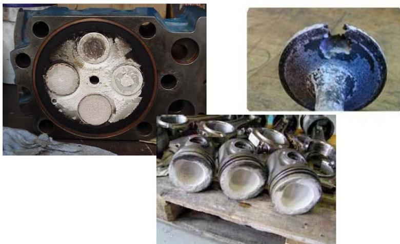
**Figura 2: Defectos en piezas de motor provocados por la silicona**
