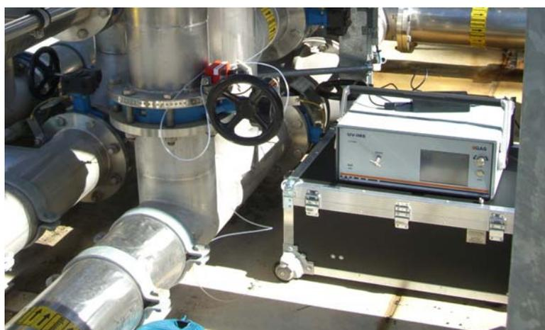
**Figure 4: GC-IMS-SILOX in-situ en una planta de biogás**
