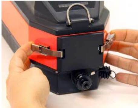
Fig. 34: Clips de bloqueo en la solapa de servicio
