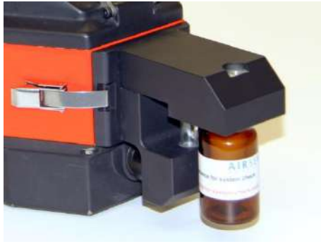
Fig. 52: Conexión del gas de test a la herramienta de comprobación
