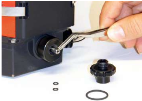
Fig. 32: Juntas tóricas en la entrada de gas
