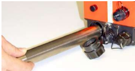
Fig. 28: Filtro de recirculación
