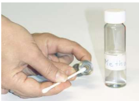
Fig. 15: Limpieza de la lámpara PID
