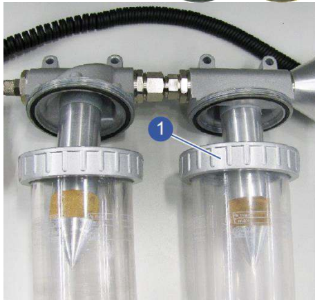
Fig. 30: Deshacer la tuerca ciega
