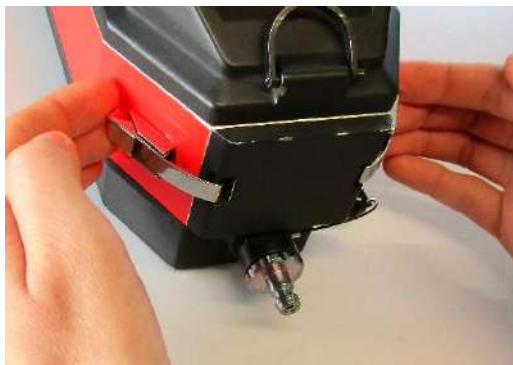
Fig. 49: Pinzas de la tapa de servicio
