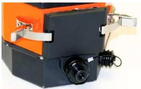
*Fig. 17: Clips de bloqueo abiertos*
