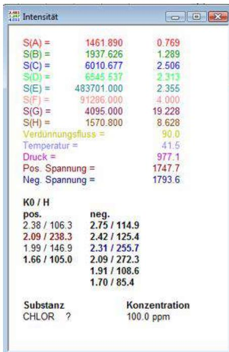
La ventana de "Intensity" con los valores actuales medidos muestra un resumen de la información de la medición, incluyendo la identificación e información del gas medido. Esto ultimo se mostrará si la librería fue cargada y el gas se encuentra en la base de datos.
