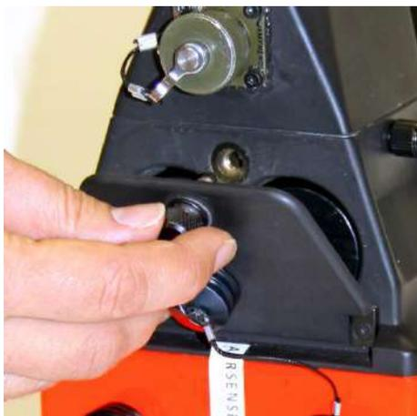
Fig. 12: Compartimento de las baterías
