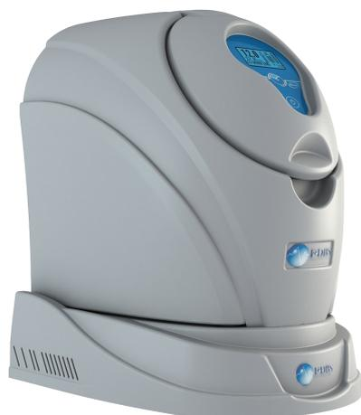
Este equipo proporciona simultáneamente hidrógeno y aire cero de calidad específica para los detectores FID de un Cromatógrafo de gases. El Hidrógeno se obtiene por electrólisis de agua desionizada mediante una membrana polimérica (PEM): Al aire se obtiene con la purificación de aire comprimido. (no incluye el compresor) "opcional". Para este equipo se requiere como suministro aire comprimido con una concentración de hidrocarburos inferior a 0.05 ppm ).
