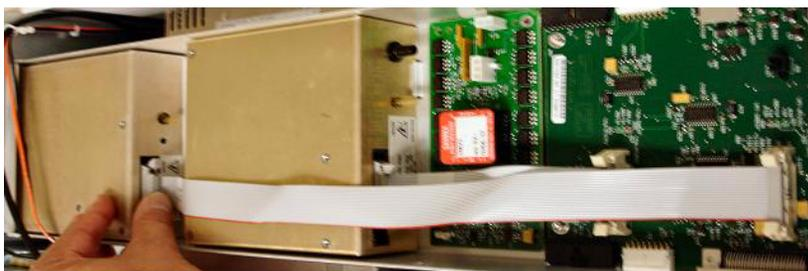
**Figura 7** Conectar la fuente de alimentación de alto voltaje a la PCA de la válvula
