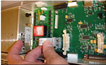
**Figura 4** Conectar la PCA de la válvula al sistema de alimentación de alto voltaje multimodo
