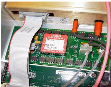
**Figura 6** Conectar los cables del Vcap y de la Vchamber a la fuente de alimentación
