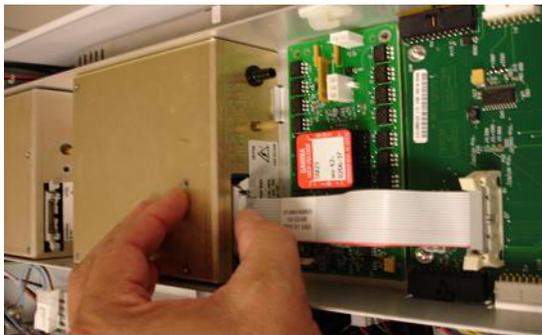
**Figura 5** Conectar la PCA de la válvula al sistema de alimentación del sistema Vcap/Vchamber
