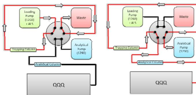
Figure 2. Back-Flush Matrix-Stripping LC Diagram
