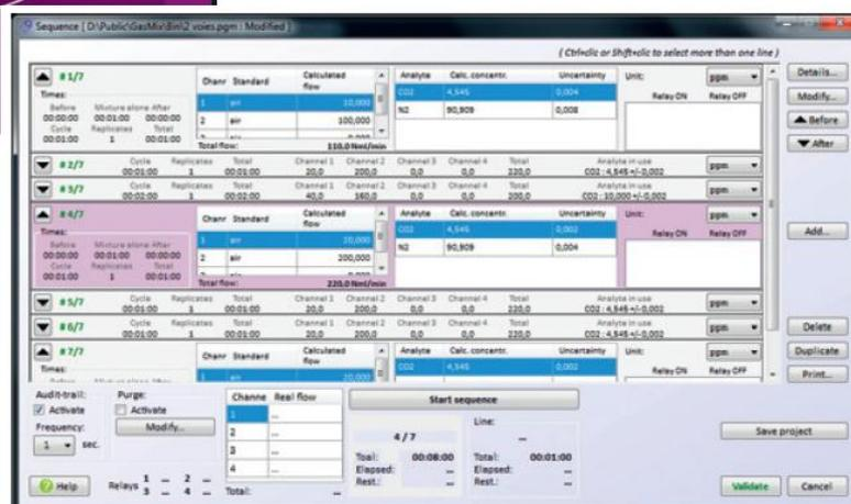
El Software CalibrateIT 12C está totalmente automatizado para generar una única inyección o una secuencia totalmente automatizada y pre-programada. El software GasMix™ CalibrateIT 12C puede ser controlado remotamente; puede controlar una válvula de inyección externa y / o el comando de inicio de un analizador. Una ventaja adicional del GasMix™ es que reduce drásticamente el tiempo del operador en la calibración e inyección de muestras de gases.
