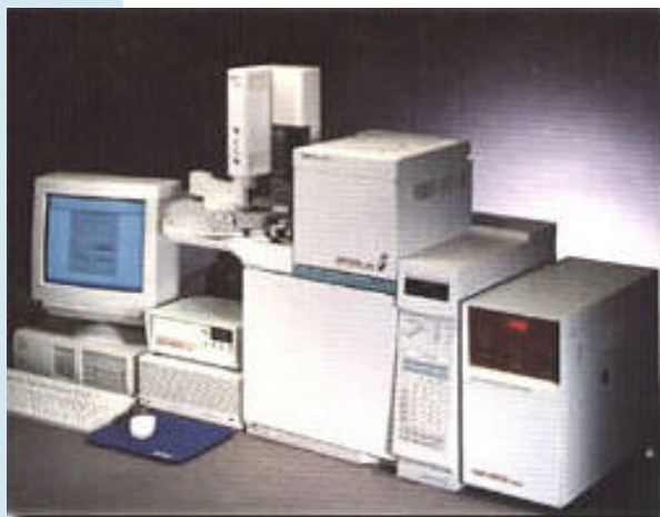
Detector 355 montado en un 6890GC de AGILENT
